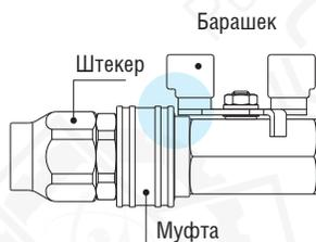
При помощи барашка клапана происходит блокировка муфты от разъединения БРС.
