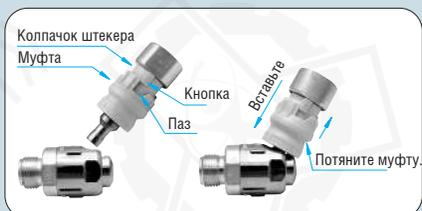
Удерживая штекер в гнезде, наклоните штекер так, чтобы совместить гнездо и штекер. Поворотом муфты зафиксируйте соединение.
