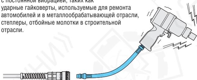
В качестве промежуточного соединения между БРС "Cupla" и вибрационным пневмоинструментом.
