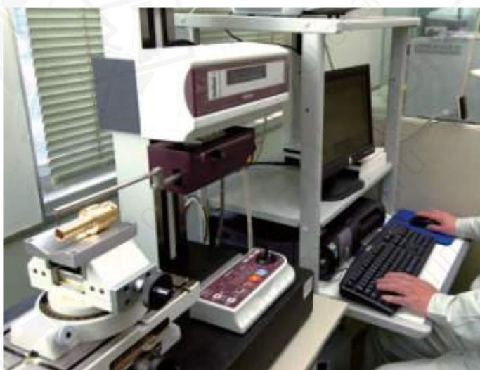
Измерительная машина для контроля размеров
