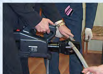
Резак REC-S3550G, провод AC 500/64
