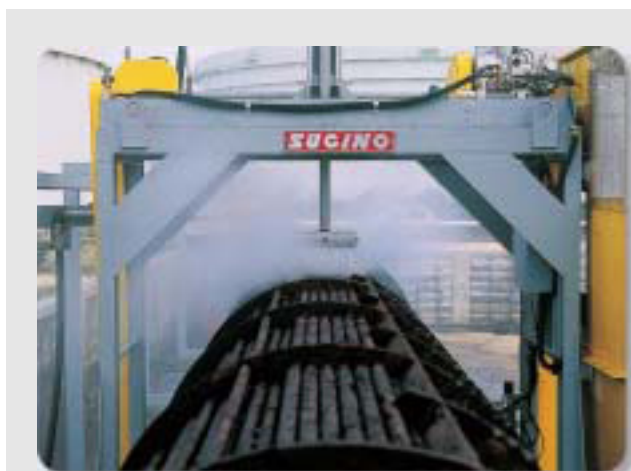
Наружняя чистка пучка труб теплообменника
