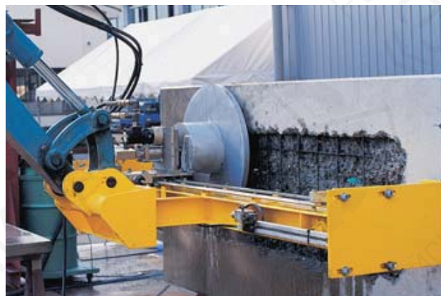
Модуль для зачистки/разрушения железобетонных конструкций навесного типа
