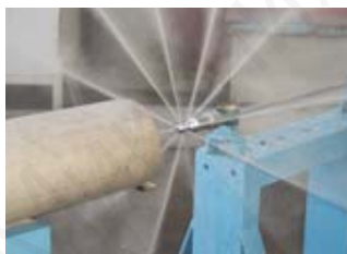
Вид струи, подаваемой через форсунку с 12-ю соплами расположенными по периметру
