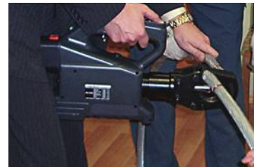
Резак REC-S3550G, провод АС 500/64
