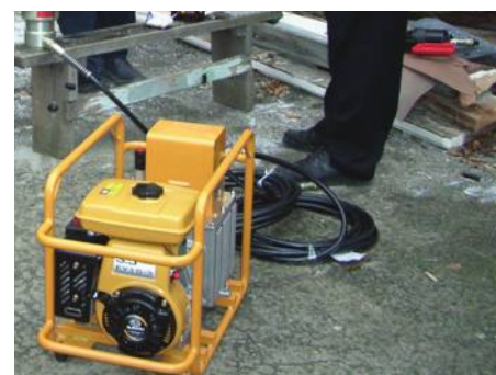
EP-100W и насосная станция HPE-4 (Новая модель идет под кодировкой HPE-160M)
