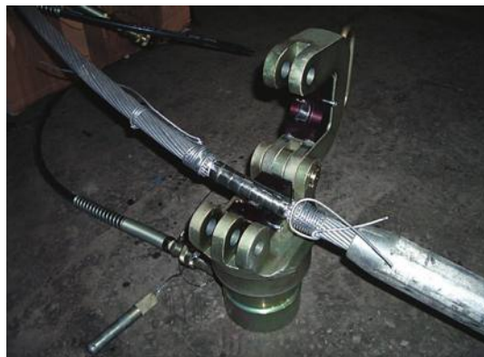
Пресс EP-520C. Опрессовка анкерного зажима соединителя CAC-300-1.
