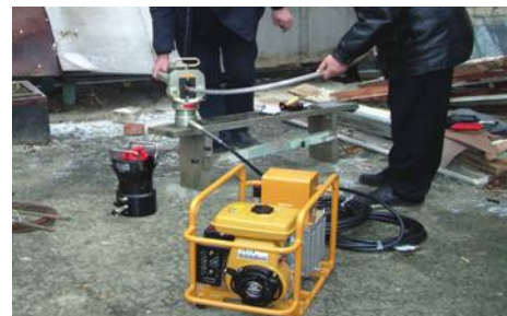
Пресса EP-520C и EP-100W и насосная станция HPE-4 (Новая модель насосной станции HPE-160M)
