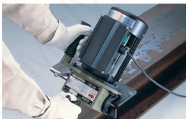
снятие фаски с кромки двутавровой балки
