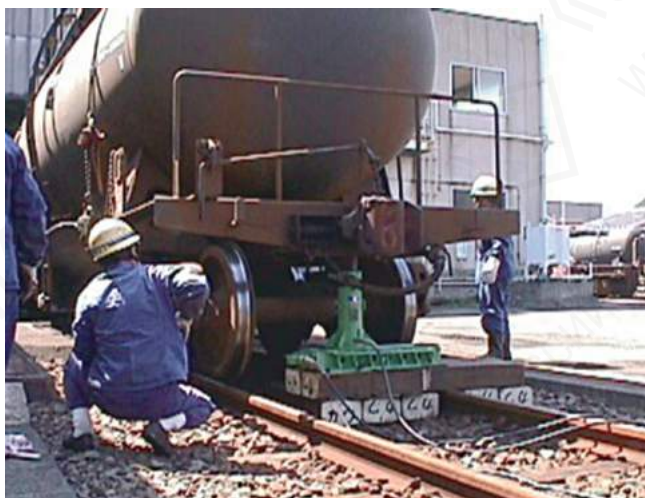
Гидравлический домкрат на скользящей опоре 500кН, 200мм и электрический насос
