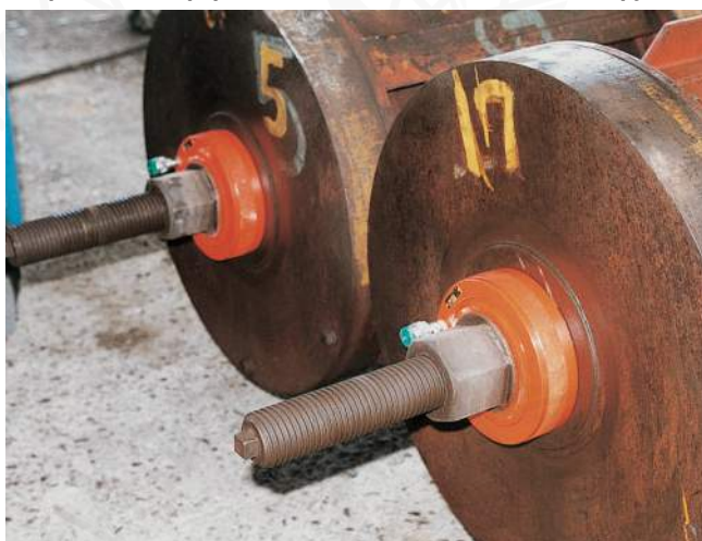
Гидравлический домкрат 1000кН, ход штока 350мм
