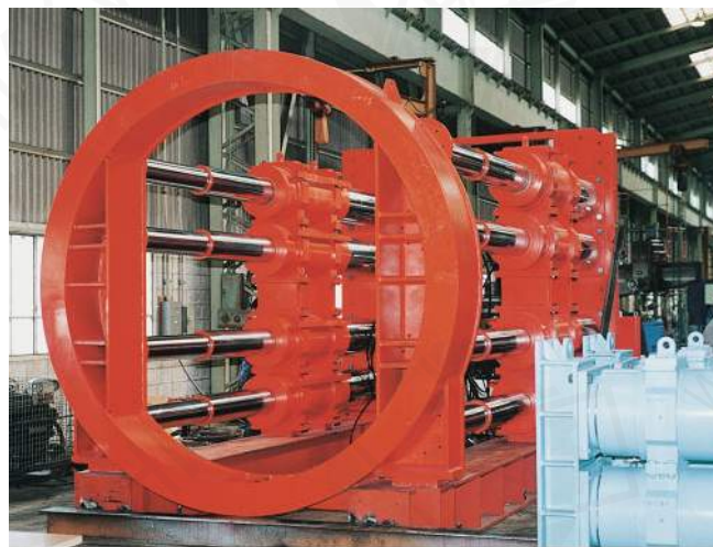
2000кН, 8 цилиндров, ход штока 3000мм
