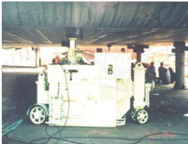
Устройство для регулировки местоположения корпуса судна 2000кН
