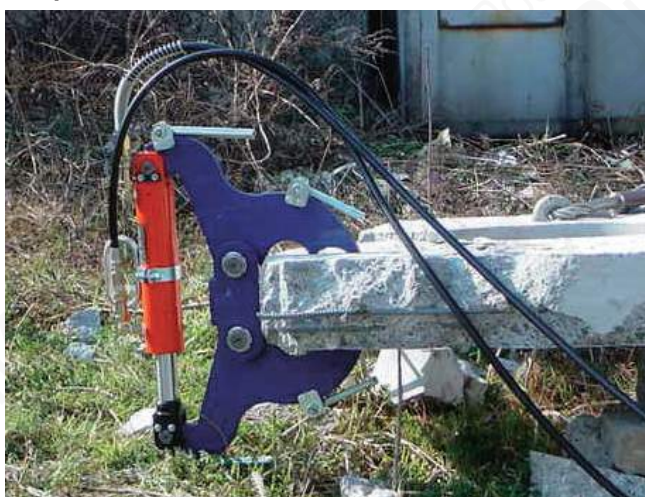
Ручная дробилка ( корпус домкрата из сплава титана)
