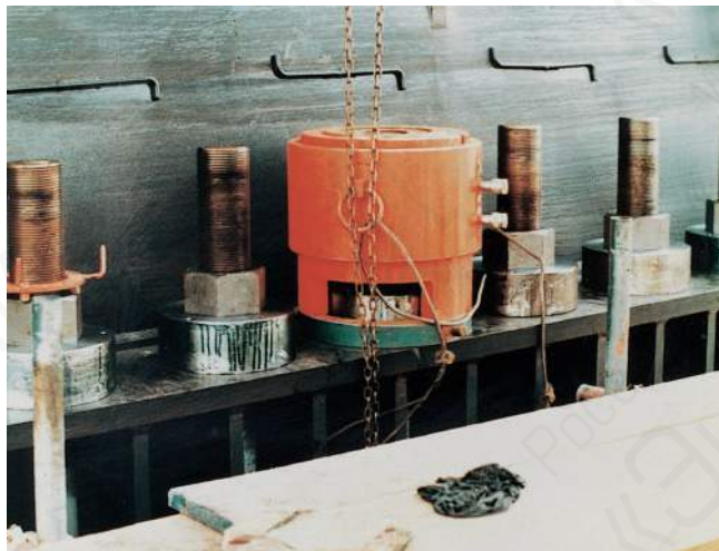
Гидравлический натяжитель болтов 5000 кН
