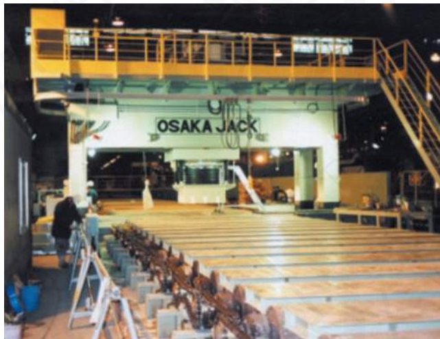
Для выпрямления листов металла на металлургических заводах
