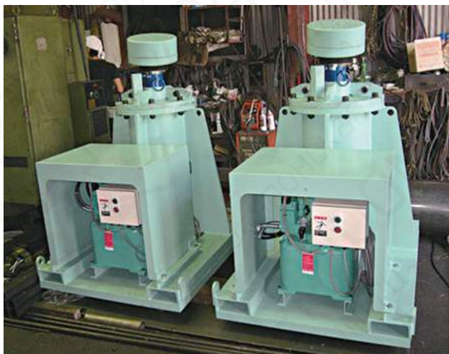
Гидравлический домкрат 500кН, 500мм и электрическая насосная станция GH2-KS-P
