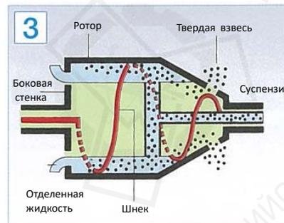
Затем винтовой транспортер с небольшим вращательным дифференциалом устанавливается на ротор. Накопившаяся в барабане твердая взвесь двигается вправо, где она осушается и выводится наружу транспортером. Шлам очищается, и чистая вода выводится из выводного патрубка на боковой плите.
